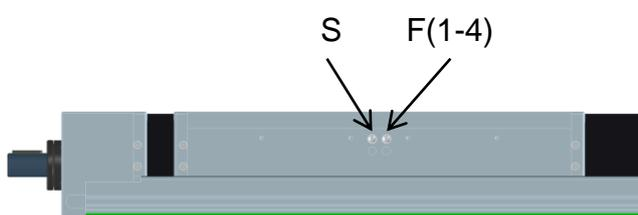
S => Schmierung Gewindetrieb
