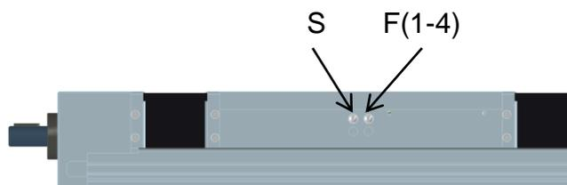
S => Schmierung Gewindetrieb
