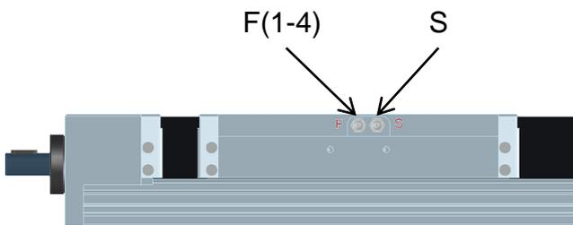
S => Schmierung Gewindetrieb
